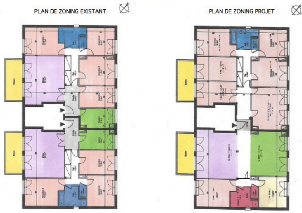
JUMELAGE DE 2 LOGEMENT MITOYENS UN COUPLE AVEC 5 ENFANTS Page 3 sur 9 ZONING AVANT/ APRES ECHELLE 1/100" AVRIL 2019
