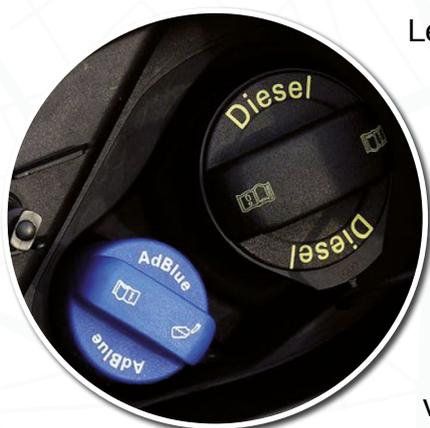
Les véhicules diesel sont équipés d'un réservoir spécifique d'AdBlue. Comme le carburant, il faut régulièrement faire le plein de cet additif.
