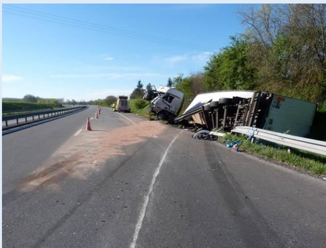
A85 – Reversement d'un camion ayant percuté la pile centrale d'un pont suite à l'éclatement d'un pneu
